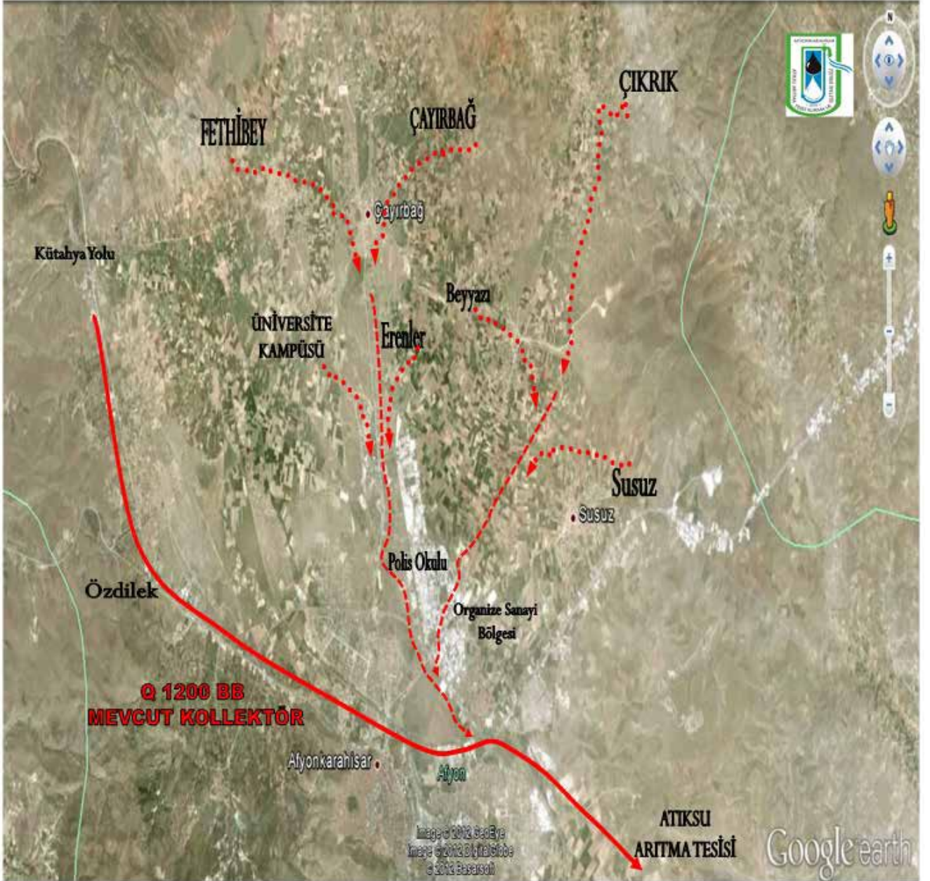
Afyonkarahisar Merkez Kuzey Yakası Kanalizasyon Kollektör Hattı.
